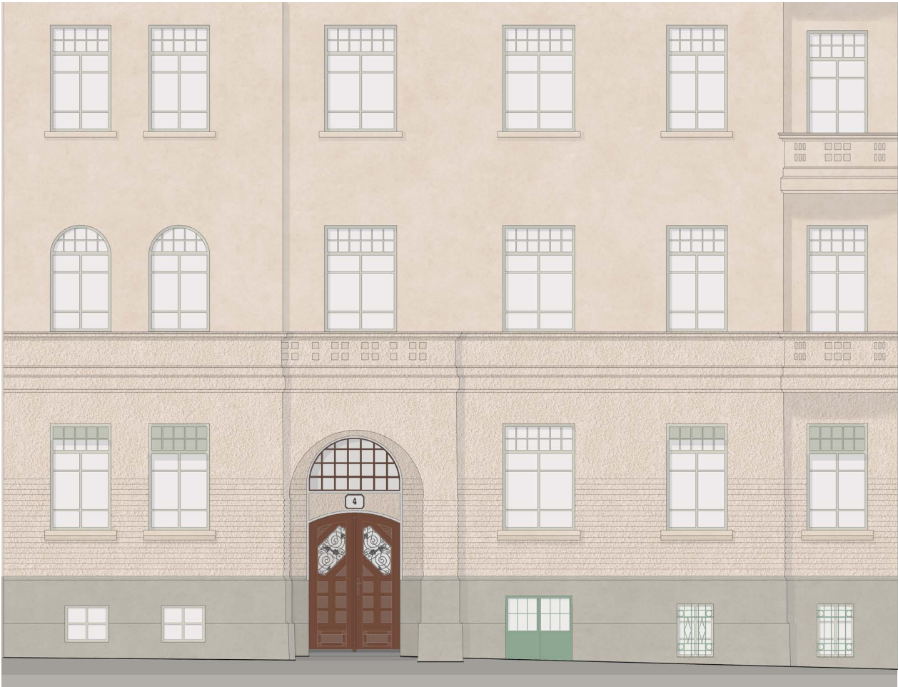
Neues Farbkonzept entsprechend der ursprünglichen Färbelung der Straßenfassade der Sonnenstraße 4.
